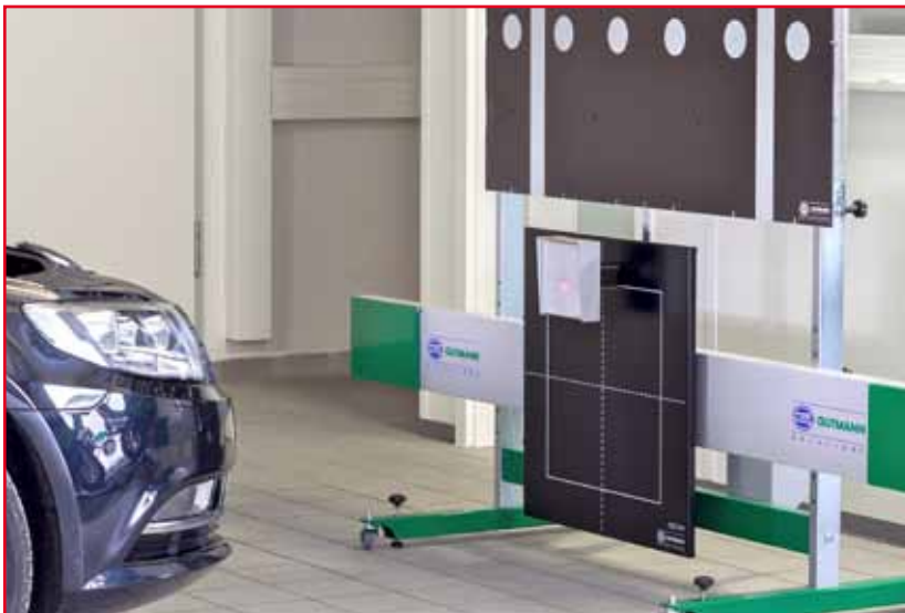
Hella Gutmann CSC-Tool mit Winkelverstellplatte für Radar-Systeme
